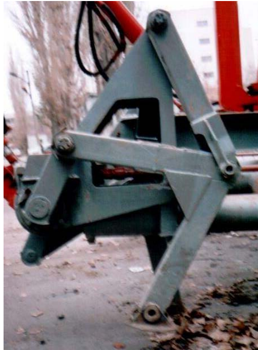
Рис. 1. Шагающий движитель со стопами «hoof-foot»
