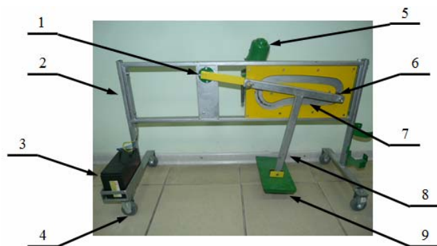
Рис. 9. Лабораторная модель циклового шагающего механизма с направляющей
